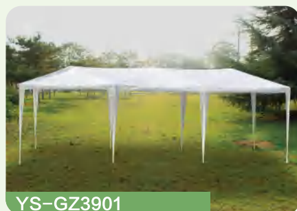
YS-GZ3901 3x9m PE gazebo w/o walls Steel tube: dia31.5/24/18mm, PE connector. Fabric: 90-100g/m2 PE
